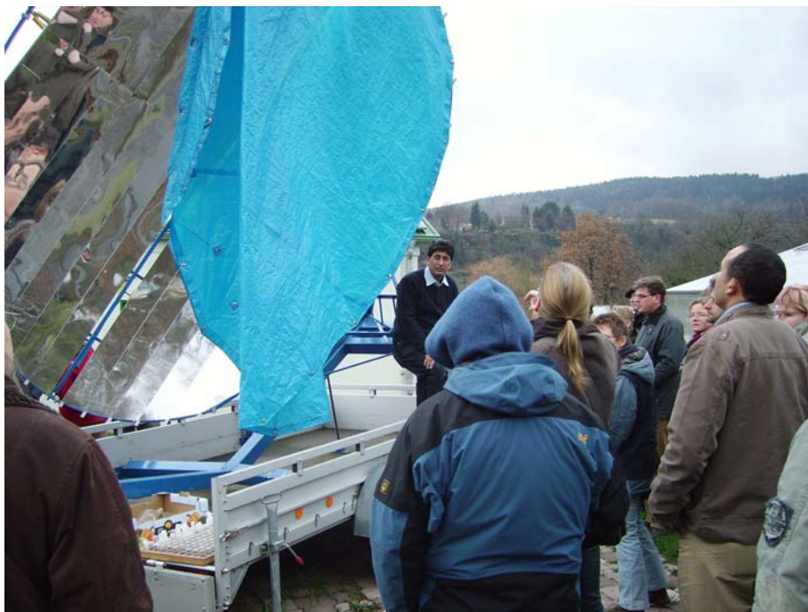
Abb. T 5: Mobile Destillationsanlage mit Scheffler Kollektor
